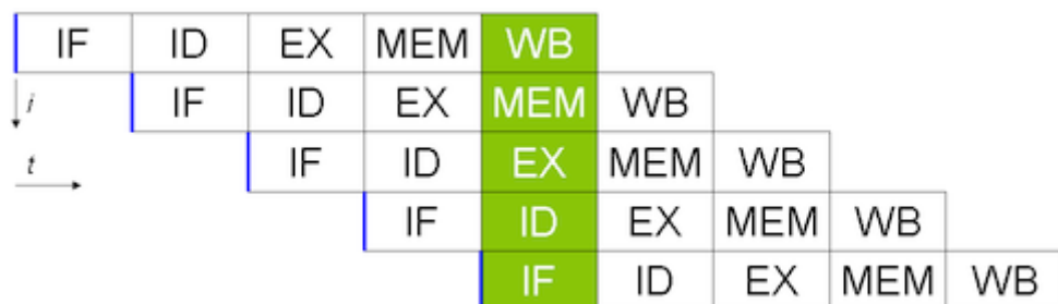
Rysunek I: Uproszczony schemat potokowości. Rozkazy zaznaczone na zielono wykonywane są równocześnie.
